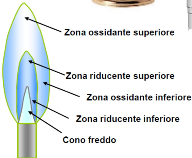
Nella fiamma del bunsen esistono diverse zone distinte per luminosità e temperatura; una zona centrale detta cono freddo costituita da gas incombusto, una zona intermedia molto luminosa detta zona riducente, in cui avviene una combustione parziale ed una zona esterna molto calda e poco luminosa detta zona ossidante, in cui si completa la combustione.
