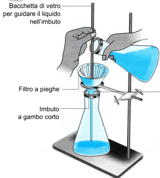
Figura 1.46 La filtrazione su imbuto per gravità viene eseguita utilizzando un filtro di carta possibilmente “a pieghe” in modo da aumentare la superficie filtrante. Il soluto solido rimarrà sul filtro, mentre il solvente passerà nella beuta inferiore.
