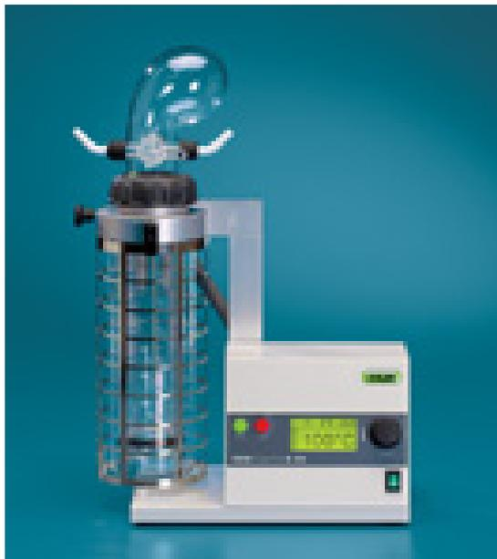
Se a T ambiente non si riesce ad eliminare il solvente di cristallizzazione (se ne rilevano le tracce per esempio ad un controllo  $^1\text{H-NMR}$ ), allora si può provare ad aumentare la T di essiccamento sfruttando **fornetti termostatabili** in cui si inseriscono pistole in vetro in cui si può fare il vuoto e contemporaneamente inserire un essiccante, es.  $\text{P}_2\text{O}_5$ .
