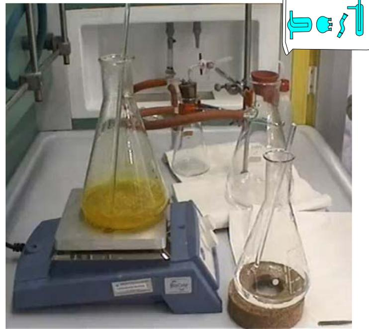
Se il solvente usato è **bassobollente** (es:  $\text{CH}_2\text{Cl}_2$ , etere), converrà inserire sul collo della beuta un **refrigerante** perché le pareti inclinate della beuta non saranno sufficienti come sistema refrigerante.
