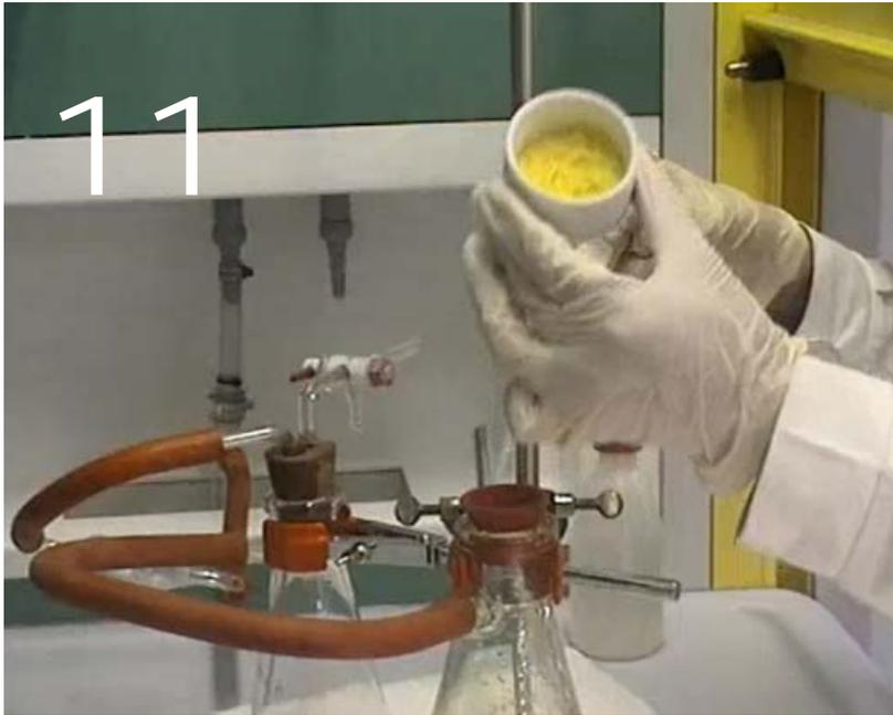
Il precipitato filtrato verrà trasferito dal filtro in un cristallizzatore e messo ad essiccare sotto vuoto con un essiccante in un essiccatore per almeno una notte.
