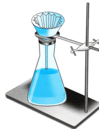
Figura 1.5 Filtrazione a caldo su filtro a pieghe.
