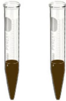
tubi da centrifuga con ppt di \text{Fe}(\text{OH})_3
