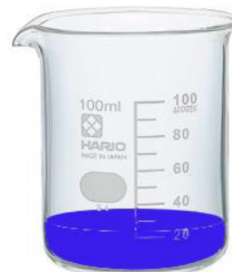
beaker con soluzione di \text{Cu}(\text{NH}_3)_4^{2+}
