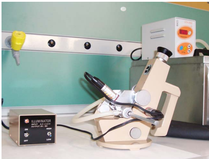
Rifrattometro di Abbé con sistema di termostattizzazione
