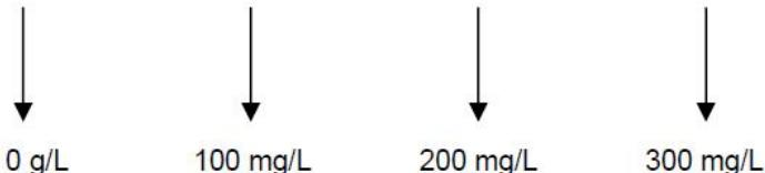
Le soluzioni così preparate rappresentano i vari punti della retta di taratura pertanto vanno diluiti 10 volte come per i vini bianchi prima di eseguire la lettura spettrofotometrica.
